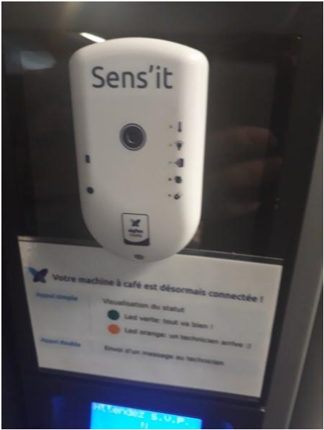
Le bouton d'alerte sur la machine à café qui permet d'alerter directement le prestataire d'une panne.
