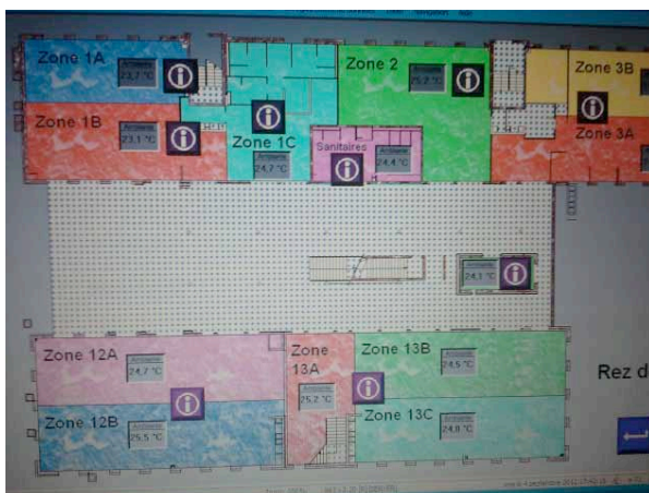
Le contrôle centralisé des températures à la Cité
